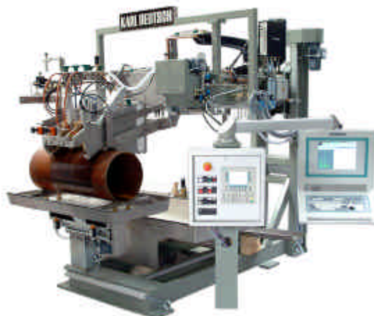
Schweißnahtprüfung am fertigen Rohr
