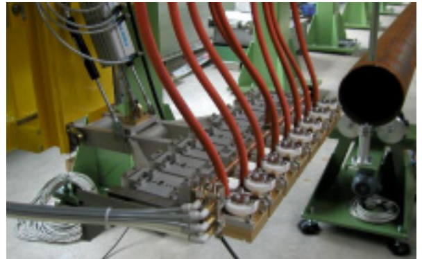
Rotierende Off-line-Volumen-Prüfung des Rohres mit 8 Prüfköpfen (Spaltankopplung).
