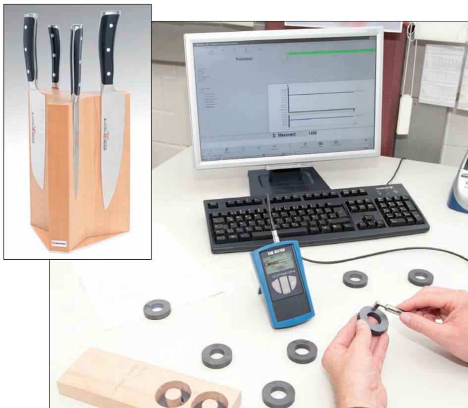
Feldstärkenmessung an Ringmagneten mit dem DEUTROMETER 3873
