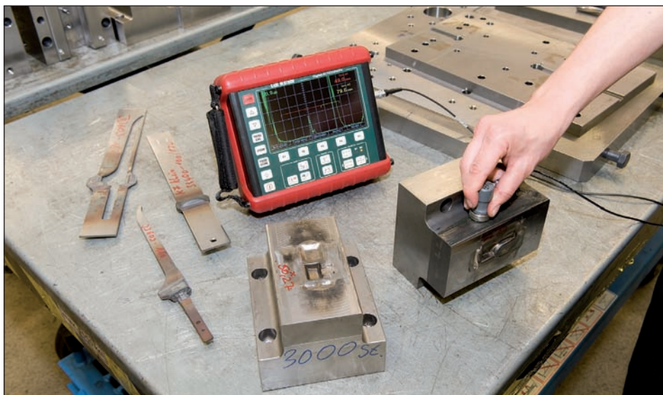
Überprüfung der Gesenke auf Risse
