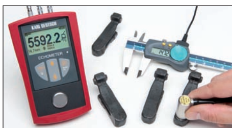
ECHOMETER 1076 mit angeschlossenem Messschieber
