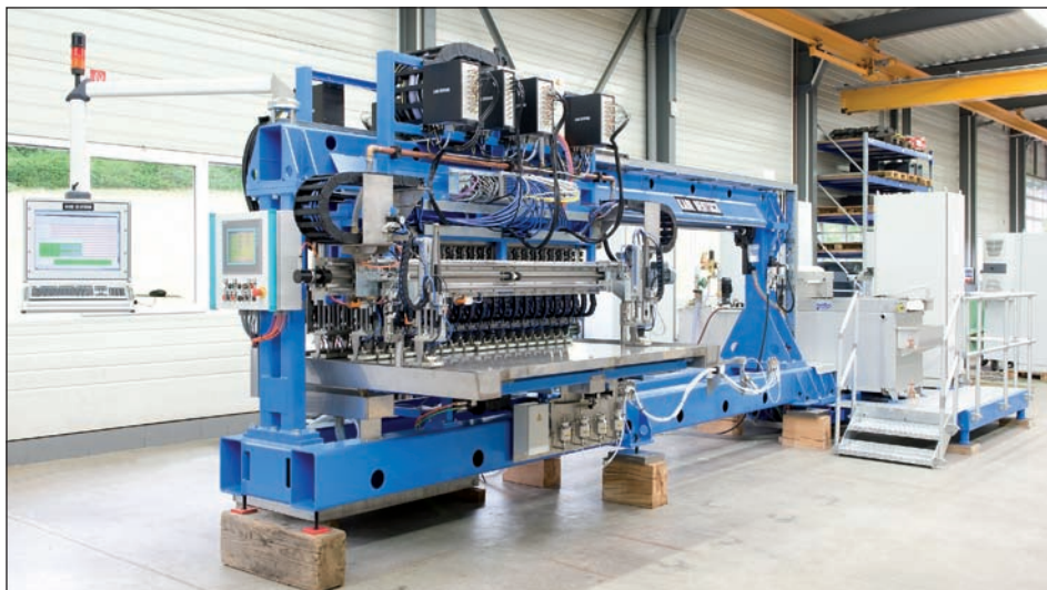
BANDPRÜFUNG Bandprüfmaschine mit 85 Prüfkäneln und 100%iger Abdeckung
