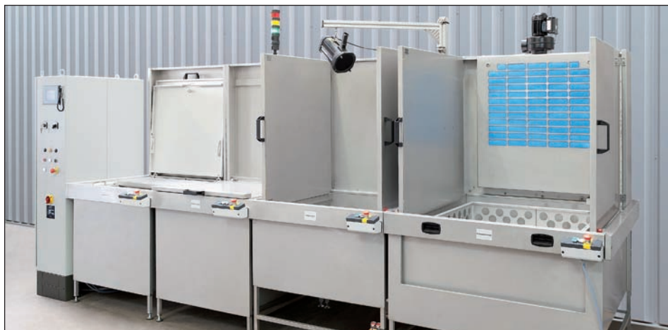
Mehrstufige Prüfanlage mit Steuerung inkl. Parameterüberwachung und -speicherung
