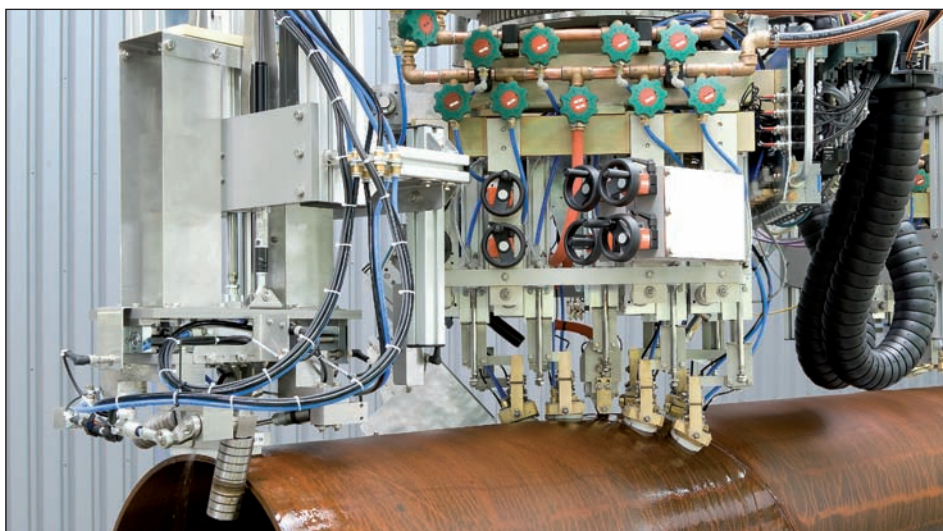
SCHWEISSNAHTPRÜFUNG Abschließende Schweißnaht- und Rohrendenprüfung mit 11 Prüfköpfen und automatischer laseroptischer Schweißnahtverfolgung
