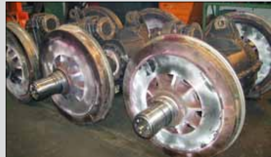
KD-Check-Farbeindringprüfung an Rädern
