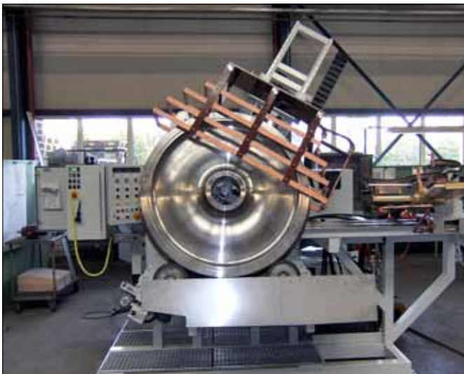
Prüfmaschine während der Inbetriebnahme mit Rad in Prüfposition
