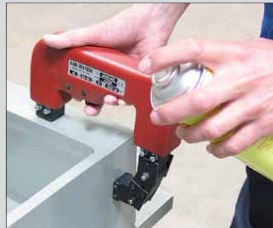
Schweißnahtprüfung mit DEUTROPULS-Handmagnet
