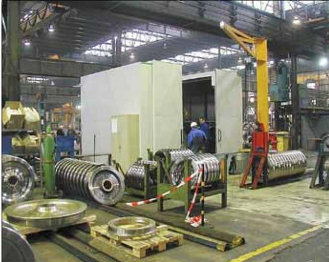
Prüfkabine und Kran zur Beladung der Maschine
