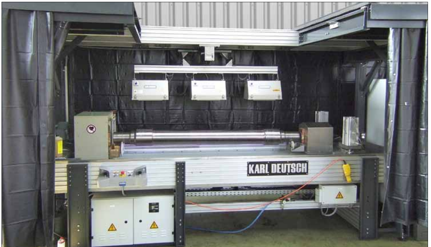
DEUTROFLUX UWS zur Achswellenprüfung: Um die gesamte Welle zu inspizieren, ist eine Drehvorrichtung vorgesehen. Drei UV-Großflächenleuchten sorgen für eine gleichmäßige Ausleuchtung. Der Lampenhalter und das Kabinendach sind pneumatisch zu bewegen, um eine Beladung per Kran zu ermöglichen.
