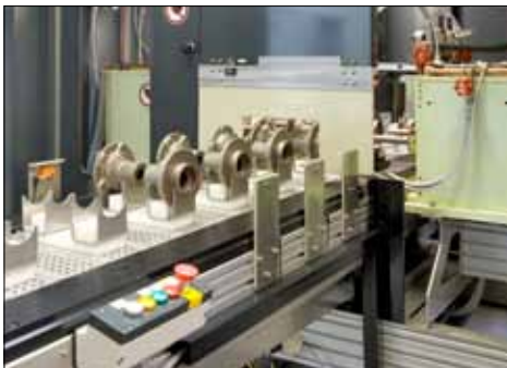
Prüfung von Radnaben (liegend)
