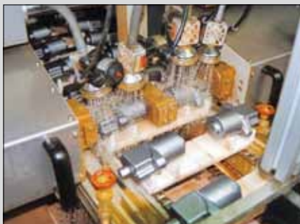
Prüfung zweier Pumpengehäuse (Einsatz eines Mittenkontakts)
