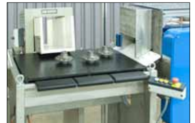
Sortierung und Entmagnetisierung
