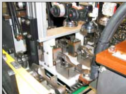
Prüfung von vier Pleueln pro Prüftakt (2 Mittenkontakte, 4 Joche)
