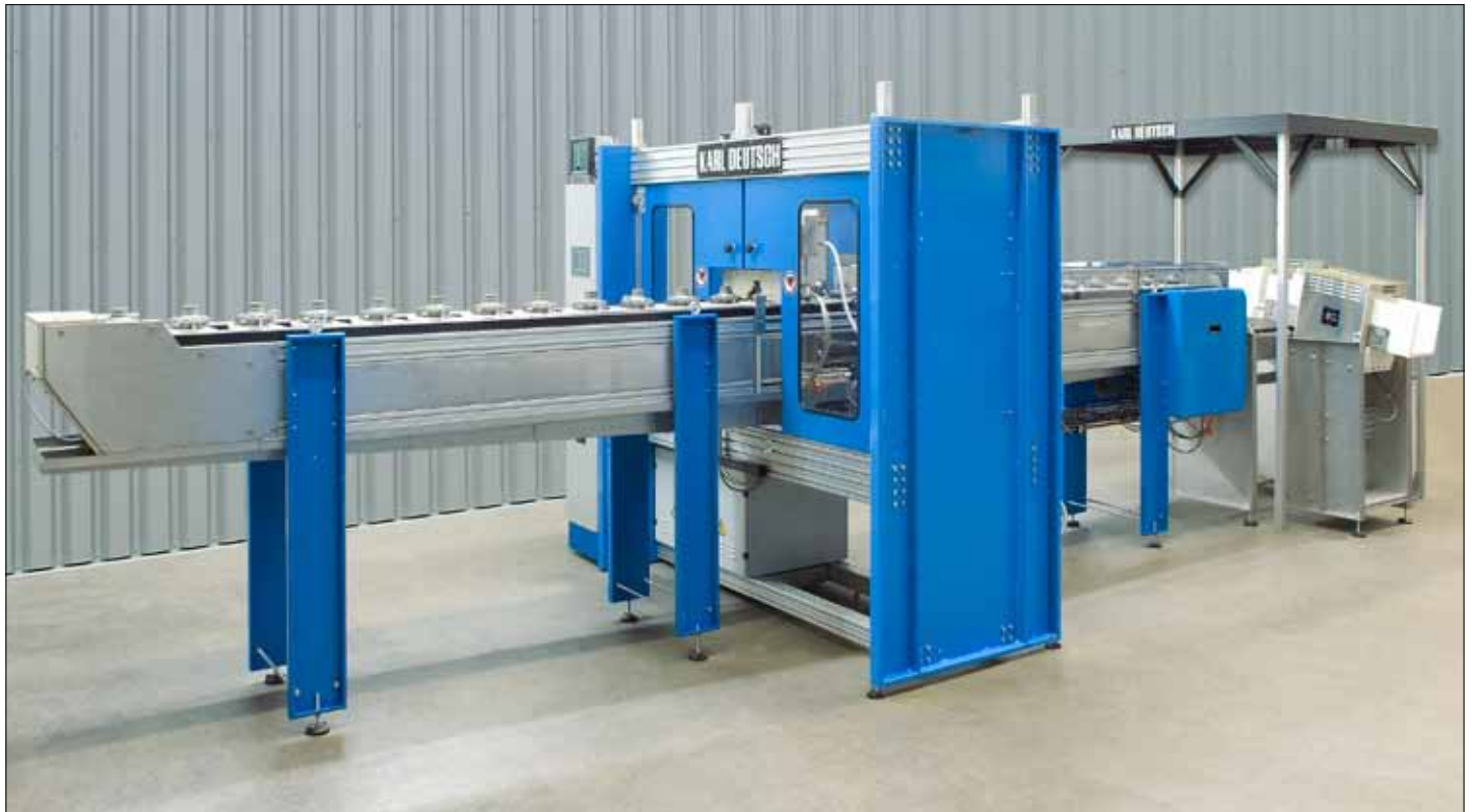
DEUTROMAT Kettentransport für Radnaben: Der Einlauf (links) verfügt über 11 Werkstückaufnahmen. Die Radnaben werden stehend transportiert. Die gekapselte Prüfstation (Mitte) verfügt über eine vertikale Magnetisierstation. Der Auslauf (rechts) endet in einer Prüfkabine (hier noch ohne Vorhänge), in der sich ein Prüftisch befindet. Die Entmagnetisierung erfolgt in diesem Fall nach der Auswertung. Durch die am Prüftisch geneigt montierten Spulen rutschen die Bauteile in Sammelbehälter.
