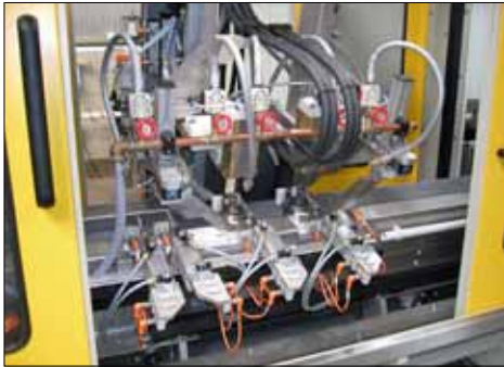
Prüfung von Radnaben (stehend)
