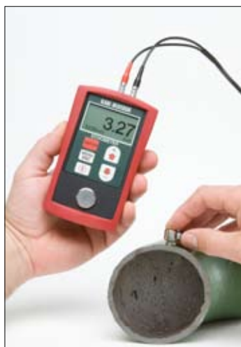
Wanddickenmessung an einem Rohr mit dem Miniaturprüfkopf
