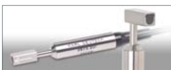
0°-Sonde und Messkopf der 90°-Sonde: Verschiedene Bauformen für unterschiedliche Werkstückgeometrien.
