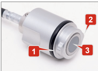
Фиг. 5: Контролна глава с изглед към изходящата повърхност на звука (сив кръг)
