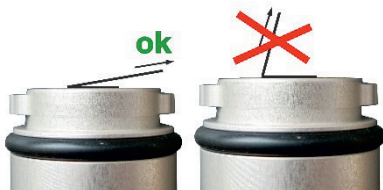
Фиг. 17: По-големите остатъци да се издърпат само под остър ъгъл (възможно най-успоредно на изходящата повърхност на звука) (вляво)
