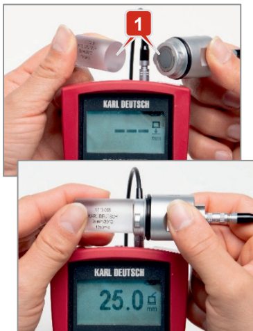
Фиг. 15: Измерване върху контролното тяло като редовно контролно измерване
