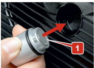
Фиг. 9: Контролна глава преди поставянето в гнездото на маслената вана (картера) на скоростната кутия
