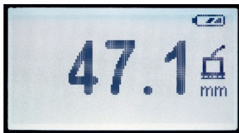
Фиг. 13: Актуална измерена стойност със символ за контакт
