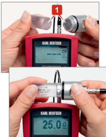
Obr. 15: Měření na kontrolním tělese jako pravidelné kontrolní měření
