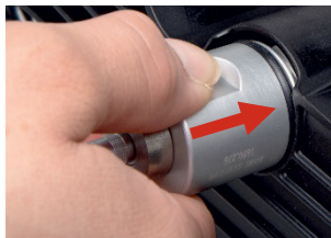
Obr. 10: Nasazení zkušební hlavy
