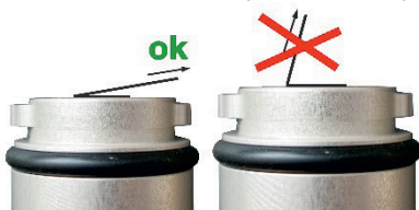
Obr. 17: Větší zbytky odstraňujte pouze v ostrém úhlu (pokud možno rovnoběžně se zvukovou výstupní plochou (vlevo))
