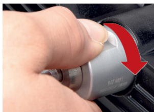
Obr. 11: Pro zablokování zatlačte zkušební hlavu a otočte směrem doprava
