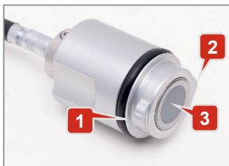
Obr. 5: Zkušební hlava s pohledem na zvukovou výstupní plochu (šedá kruhová plocha)
