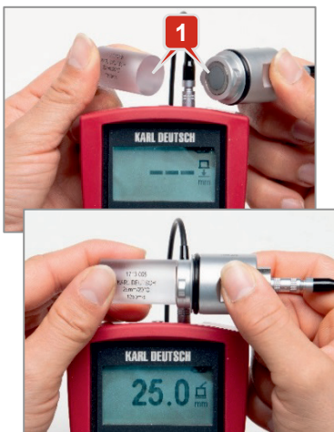
Billede 15: Måling på kontrollegemet som regelmæssig kontrolmåling
