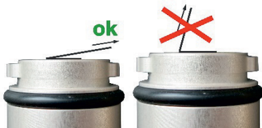
Billede 17: Fjern større rester kun i en spids vinkel (helst parallelt med lydudgangsfladen)
