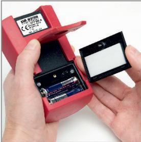
**Figura 6: Abrir el compartimento de la batería**
