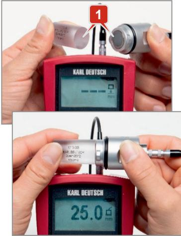
Figura 15: Medición en la unidad de control como medición de control regular
