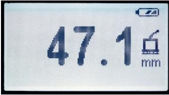
Figura 13: Valor de medición actual con símbolo de acoplamiento
