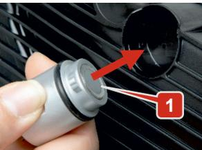
Figura 9: Sonda antes de insertarla en la toma del cárter de aceite de la transmisión
