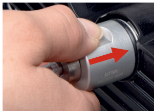
Pilt 10: Kontrollpea paigaldamine
