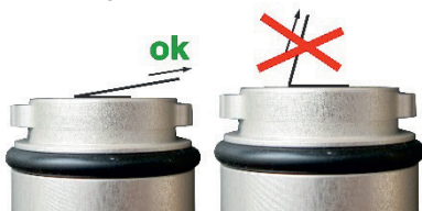
Pilt 17: Eemaldage suuremad jäägid ainult teravnurga all (võimalusel heli peegeldava pinnaga paralleelselt (vasakul))
