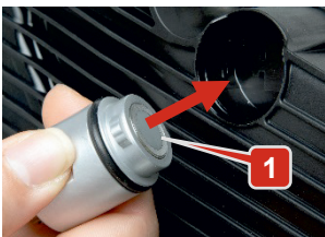
Pilt 9: Kontrollpea enne käigukasti õlivanni pesa paigutamist
