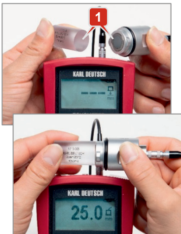
Pilt 15: Mõõtmine kontrollkorpusel regulaarse kontrollmõõtmisena
