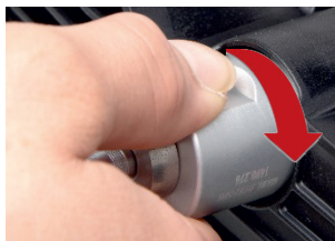
Pilt 11: Lukustamiseks vajutage kontrollpea sisse ja keerake paremale
