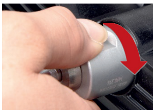
Kuva 11: Lukitse painamalla testipää paikalleen ja kiertämällä oikealle
