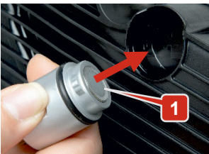
Kuva 9: Testipää ennen vaihteistoöljypohjan kantaan kiinnittämistä
