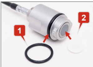
Kuva 8: Kuva testipäästä, O-renkaasta (1) ja pyöreästä suojalevystä (2)
