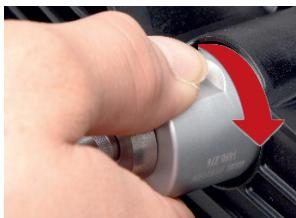
Slika 11: za zaključavanje ispitnu glavu utisnite i okrenite udesno
