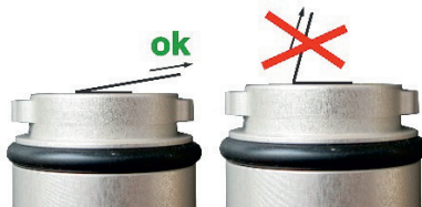
Slika 17: Veće ostatke skidati samo pod oštrim kutom (ako je moguće paralelno s površinom za izlaz zvuka) (lijevo)
