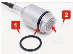
Slika 8: Pogled ispitne glave s O-prstenom (1) i okruglim zaštitnim diskom (2)
