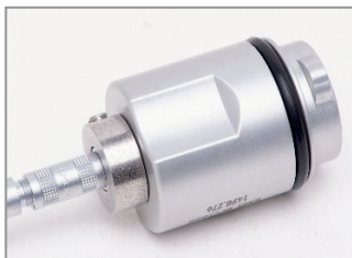
Slika 4: pogled sa strane ispitne glave s priključnim kablom
