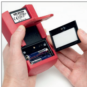
Slika 6: otvorite odjeljak za baterije
