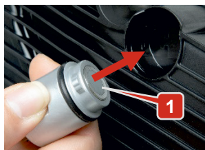
Slika 9: ispitna glava prije nego što je umetnete u utičnicu korita za ulje prijenosnika
