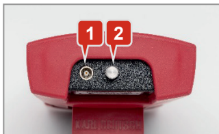
Slika 2: Priključna utičnica s ušicom za nošenje za petlju za nošenje
