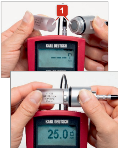
Slika 15: Mjerenja na kontrolnom tijelu kao redovito kontrolno mjerenje
