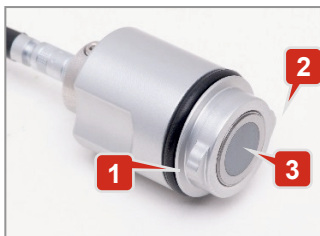
Slika 5: ispitna glava s pogledom na izlaznu površinu zvuka (siva kružna površina)
