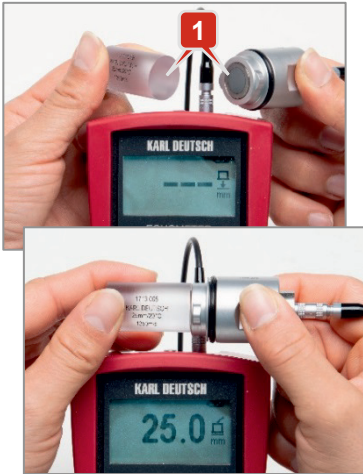
ábra 10: Mérés az ellenőrzőtesten rendszeres ellenőrző mérésként
