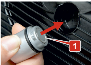
9. ábra: Vizsgálófej hajtómű olajtekno foglalatba való behelyezés előtt
