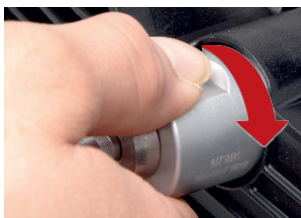
6 ábra: A reteszeléshez nyomja meg a vizsgálófejet és forgassa el jobbra
