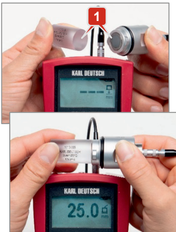
Mynd 15: Mæling á viðmiðunartæki sem regluleg viðmiðunarmæling
