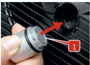
図 9: トランスミッションのオイルパンのソケットに差し込む前の検査ヘッド
