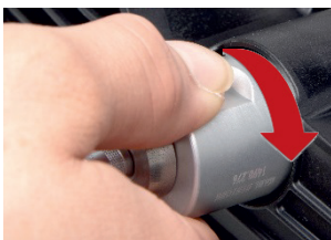
図 11: ロックするために検査ヘッドを押し込み、右方向に回します
