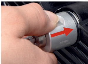
図 10: 検査ヘッドの挿入
