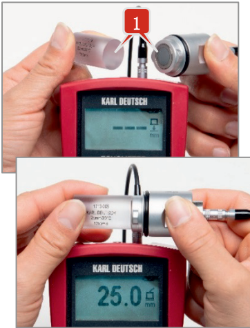
図 15: 定期的な制御計測としての制御器での計測
