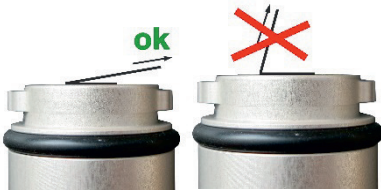
図 17: 大きな残余は、必ず鋭角で（できるだけ音波発信面に水平にして）引きはがしてください（左）
