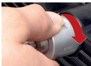
11 paveikslėlis. Tikrinimo galvutė užfiksuojama įstumiant ir pasukant į dešinę.
