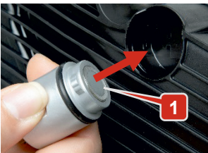
9 paveikslėlis. Tikrinimo galvutė prieš įdedant į lizdą pavaros alyvos vonelėje.
