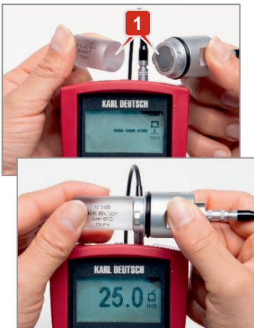
15. attēls. Mērījums ar kalibrēšanas bloku kā regulārs kontrolmērījums
