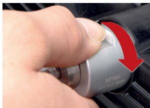
11. attēls. Lai nofiksētu, mērgalvu iespiediet un pagriežiet pa labi
