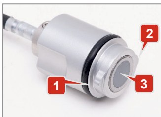
Afbeelding 5: Testkop met zicht op het geluidsuitgangsooppervlak (grijs cirkelvormig vlak)
