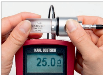
Afbeelding 15: Meting op het referentieblok als reguliere controlemeting
