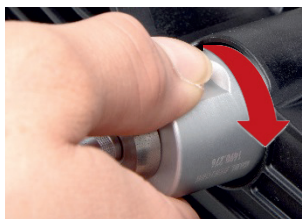
Fig. 11: Trykk inn testhodet og vri det mot høyre for å låse det
