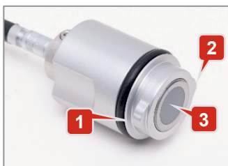
Fig. 5: Testhode med visning av lydutgangsflaten (grå sirkulær flate)
