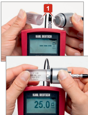
Fig. 15: Måling på kontrollorgan som regelmessig kontrollmåling
