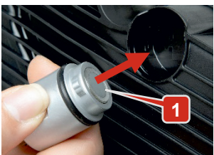
Rys. 9: Głowica przed osadzeniem w oprawie wanny olejowej skrzyni biegów
