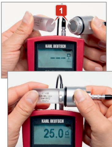
Figura 15: Medição no bloco de controlo como medição de controlo regular
