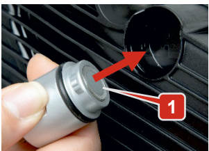
Figura 9: Cabeça de teste antes de inserir no suporte do cárter do óleo de engrenagem
