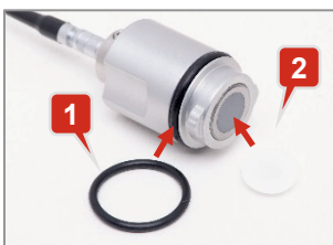
Figura 8: Vista da cabeça de teste com o-ring (1) e disco de proteção redondo (2)
