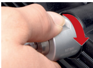
Figura 11: Para bloquear, pressione e rode a cabeça de teste para a direita
