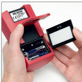
Figura 6: Abrir o compartimento das pilhas
