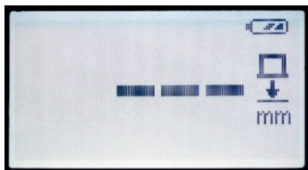
Imaginea 12: Nicio măsurare: Trei linii orizontale și simbolul capului de verificare ridicat
