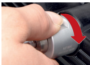
Imaginea 11: Pentru blocarea capului de verificare se apasă înăuntru și se rotește la dreapta
