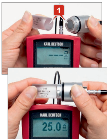
Imaginea 15: Măsurare pe corpul de control ca și măsurătoare de control regulată
