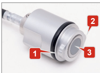
Imaginea 5: Cap de verificare cu vedere asupra suprafeței de ieșire a sunetului (suprafața circulară gri)
