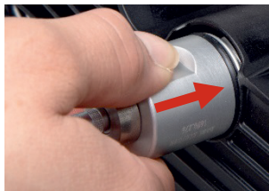
Imaginea 10: Introducerea capului de verificare
