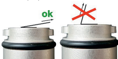
Imaginea 17: Resturile mai mari se scot numai într-un unghi ascuțit (pe cât posibil paralel față de suprafața de ieșire a sunetului)
