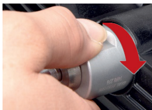
Obr. 11: Na zablokovanie skúšobnú hlavu zatlačte a otočte smerom doprava
