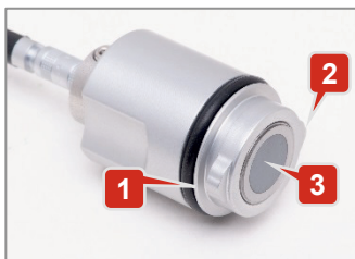
Obr. 5: Skúšobná hlava s pohľadom na zvukovú
