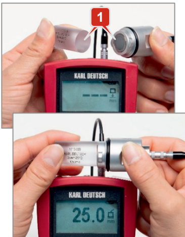
Obr. 15: Meranie na kontrolnom telese ako pravidelné kontrolné meranie
