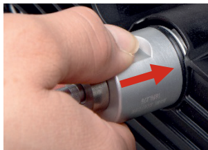
Obr. 10: Nasadenie skúšobnej hlavy
