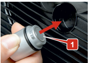
Obr. 9: Skúšobná hlava pred nasadením do objímky olejovej vane prevodovky
