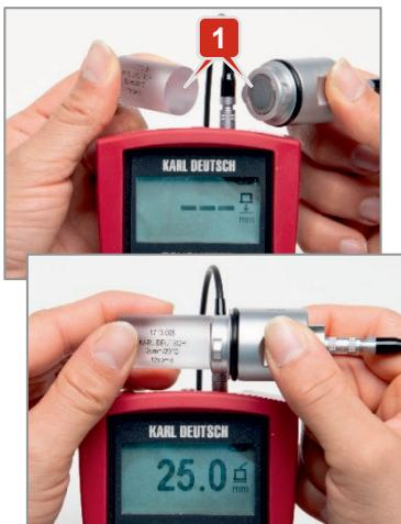
Slika 15: Meritev na preizkuševalniku kot redna kontrolna meritve
