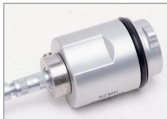
Priključni kabel kontrolne glave (št. art.: 1498.276) je priključen na zadnji strani (na sliki levo) in ga je mogoče enostavno izvleci in izklopiti. (Ne vlecite za kabel! Pri izvleku kabla je treba prijeti za vtič!)
