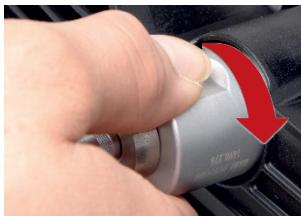
Slika 11: Za zapahnitev kontrolno glavno pritisnite in zavrtite v desno
