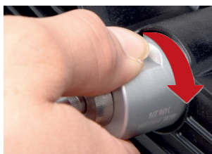
Fig. 11: Tryck in mät huvudet och vrid det åt höger för att låsa fast det
