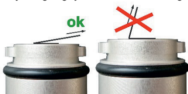
fig. 17: Grövre rester ska endast dras bort i spetsig vinkel (så parallellt som möjligt med ytan) (vänster)
