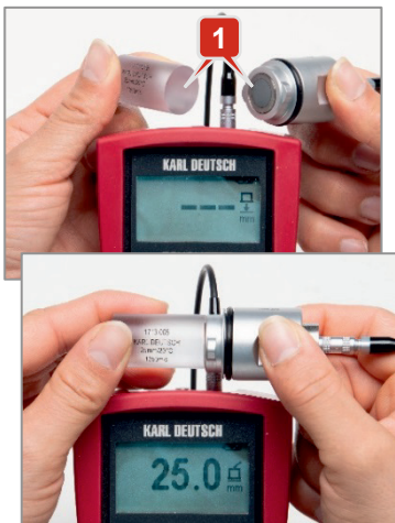
Fig. 15: Mätning på provkroppen som regelbunden kontrollmätning
