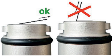
Resim 17: Büyük ebatlı kalıntılar sadece sivri açı ile (mümkün derece yankı çıkış noktasına paralel olarak) çıkartılmalıdır (sol)
