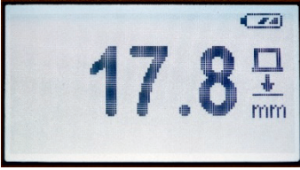
Resim 14: Kenetleme sembolü ile birlikte en son ölçülmüş olan ölçüm değeri. Bu kenetleme sembolü ile ölçüm değeri güncel değildir.
