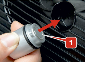
Resim 9: Kontrol kafasını şanzıman yağ karteri kavramasına yerleştirmeden önce
