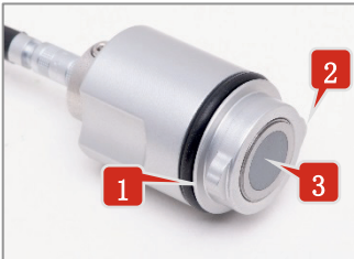
图 5:探头声波出射面视图（灰色圆形区域）
