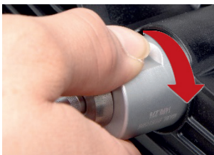
图 11：插入探头并右转以锁定
