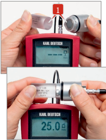
图 15: 在比照标准样上进行定期校验测量
