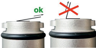
图 17: 只能小角度（尽量平行于声波出射面）去除大的残留物（左侧）
