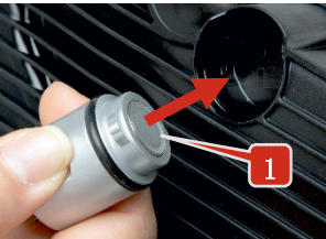
图 9:将探头插入变速箱油底壳插座前
