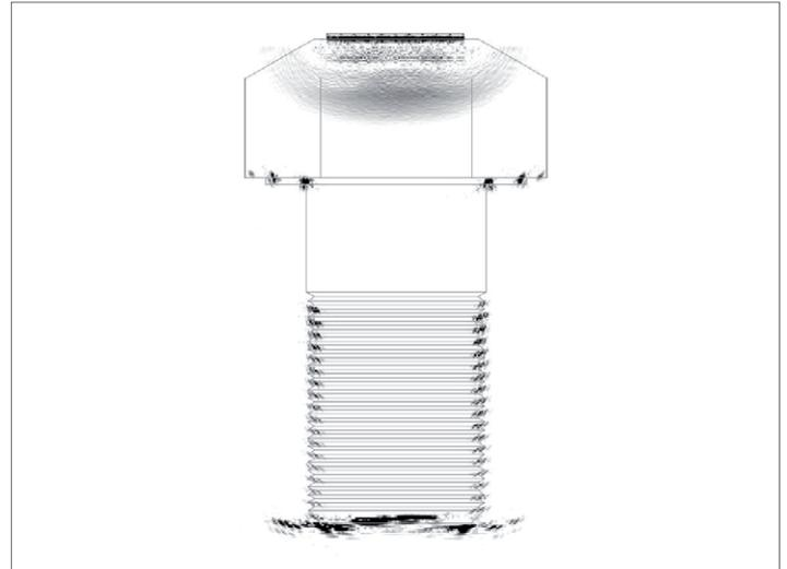
TFM-Darstellung einer Schraube mit Graustufenskala bei kopfseitiger Einschallung
