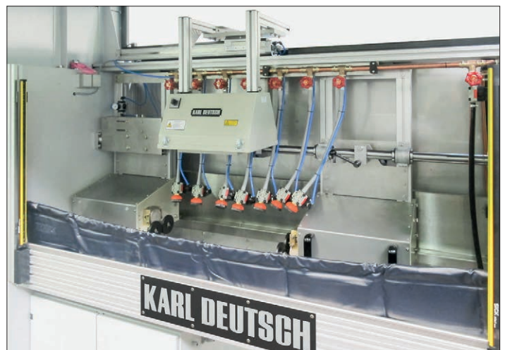
UWE 900 mit pneumatisch verschiebbarem Leuchtenhalter zur einfacheren Beladung des Bauteils von oben (auch mit Lichtschranke)
