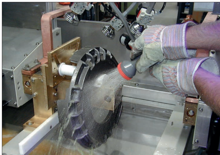
UWE 900 mit Magnetisierdorn zur Prüfung von ringförmigen Teilen. Hier Besspülung mit Handbrause, Spannhub beidseitig.
