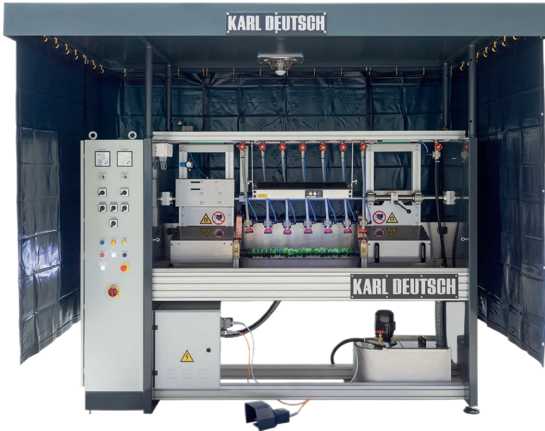
UWE 900 mit angeflanschter Verdunklungskabine (im Bild ohne vordere Vorhänge)
