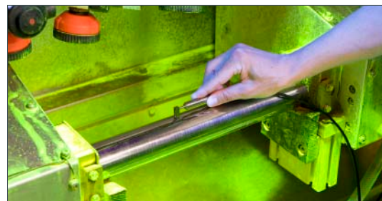
Anwendungsbeispiel: Tangentialfeldmessung mit der 90°-Sonde bei Felddurchflutung
