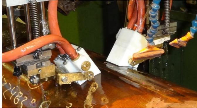
**Abb. 3.** Längsfehlerprüfung mit Fließwasserankopplung
