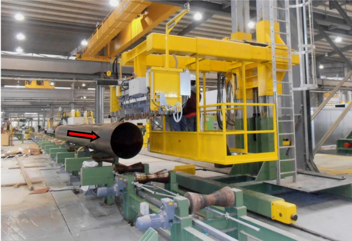
**Abb. 14.** SNUL-Prüfanlage für die Rohrlängsnahtprüfung mit bewegtem Rohr
