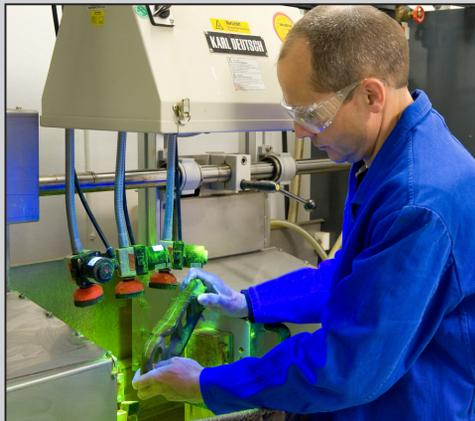
Rissbewertung in Prüfmaschine
