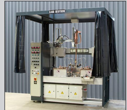
Prüfmaschine mit Verdunklungskabine
