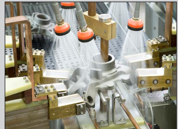
Achsschenkel-Prüfung (6 Kontakte, Auswerfer)
