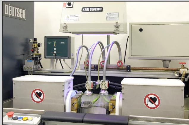
FLUXA-Control zur Überwachung des Rissprüfmittels
