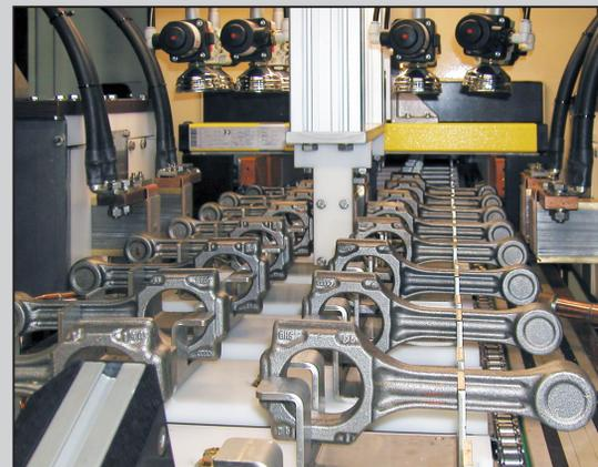
Pleuel-Prüfung mit Kettentransport (4 Teile pro Takt)
