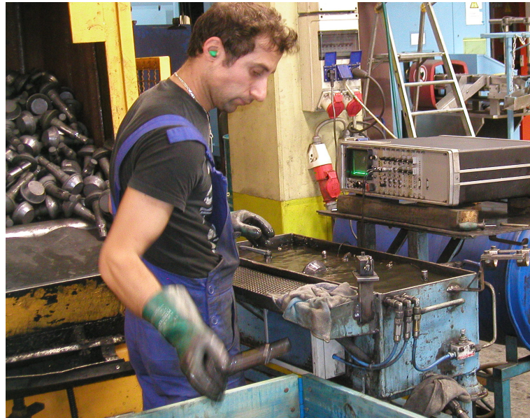
Bild Prüfstand Wellenprüfung. Älterer Prüfstand mit manueller Beschickung und analoger Prüfelektronik.
