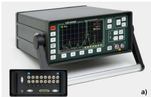
Bild Grobblechprüfung a) ECHOGRAPH 1094 mit eingebautem 8-kanaligen Multiplexer, b) Prüfkopfhalterungen eines Blechrollers, Bauart KARL DEUTSCH.
