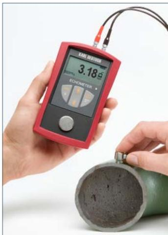
Wanddickenmessung an einem Rohr mit dem Miniaturprüfkopf
