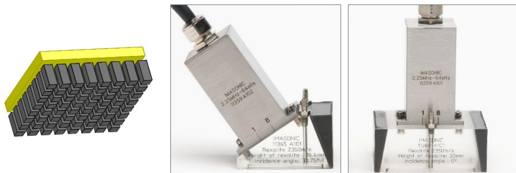
Abb. 9: Matrix-Array mit 8 \times 8 Elementen mit ebenem und Winkelvorlauf
