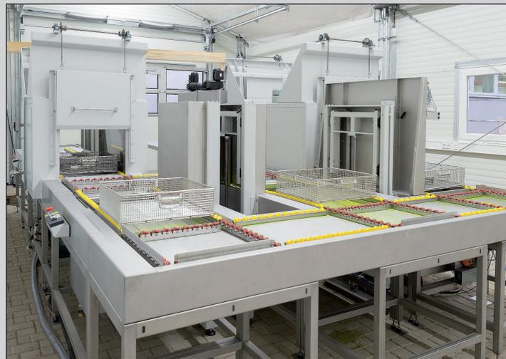
U-förmig angeordnete Prüfanlage, Bauteiltransport in Edelstahl-Körben über Röllchenbahnen
