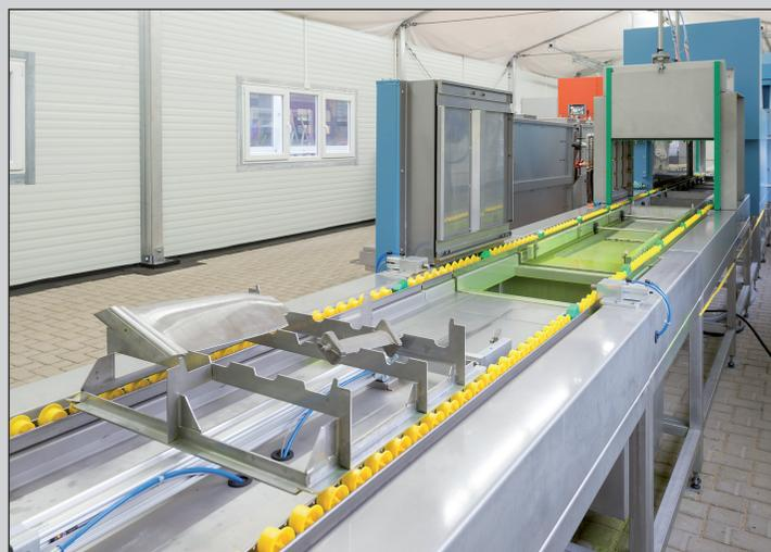
Linearer Bauteiltransport in Werkstückträgern, Vorschub im 3-Minuten-Takt
