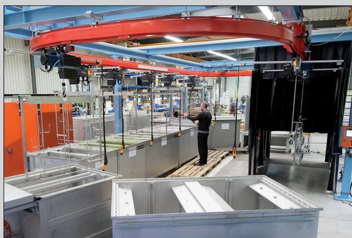
Ovale Kranbahn zum Transport der Werkstückträger, rechts Prüfkabine zur Auswertung
