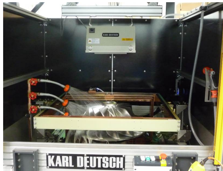
Bild Kontaktlose Magnetisierung. Prüfung eines rundlichen Prüfteils, dessen sensible Oberflächen eine Einspannung nicht zulassen. Durch die runde Bauteilgeometrie wird eine Prüfung mit einer Kreuzspule möglich.
