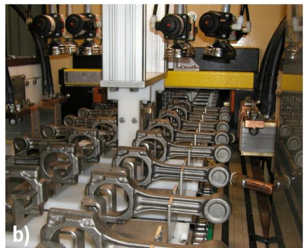
Bild Maschine mit Kettentransport für 4 Teile pro Takt. Pro Takt werden vier Pleuel mit zwei horizontalen Magnetisierstationen und zwei Mittenkontakten geprüft. a) Einlauf der Prüfmaschine, b) Detail der Magnetisierung.
