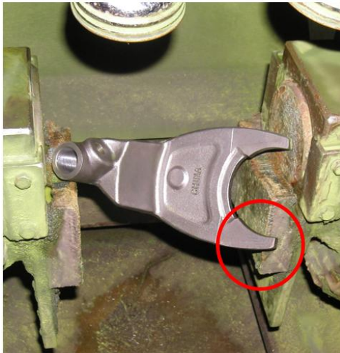
Bild Mangelhafte Prüftechnik. Bei beiden gezeigten Prüfteilen wäre zur Optimierung der Magnetisierung eine Prüfung mit drei Kontakten ratsam. Im linken Beispiel wird der markierte Teilbereich ungeprüft bleiben. Im rechten Beispiel ist nicht sichergestellt, dass sämtliche Oberflächen ausreichend und reproduzierbar magnetisiert werden.
