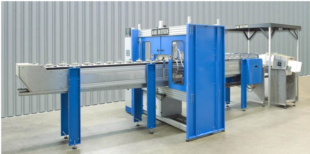
Bild Maschine mit Kettentransport. Die Bauteile (Radnaben) laufen von links nach rechts durch die gekapselte Prüfmaschine. Die liegenden Radnaben werden durch eine vertikale Magnetisierstation geprüft. Im Auslauf ist die Betrachtungskabine (noch ohne Vorhang) zu sehen.
