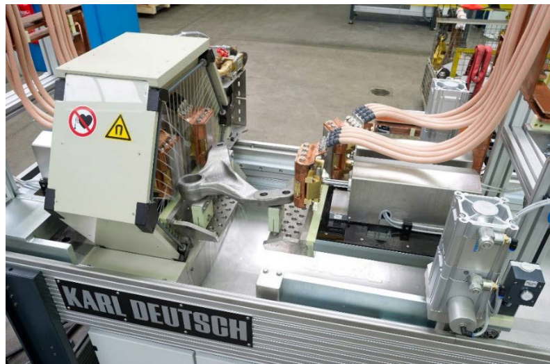
Bild Mehrkontaktprüfung mit Spule. Für komplex geformte Bauteile wurde dieser Maschinentyp auf vier Stromkontakte erweitert (im Bild sind davon drei im Einsatz).
