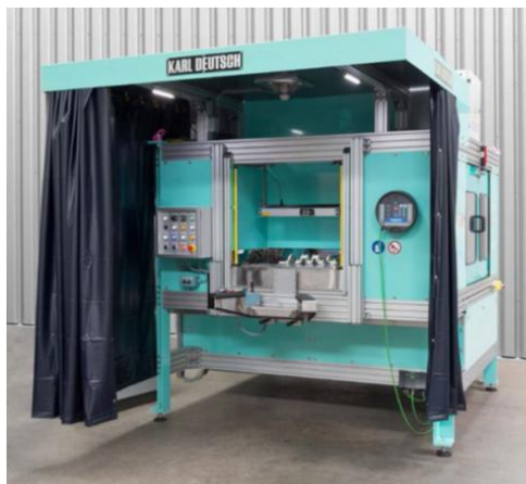
Bild Rundtaktisch. Auch ein Rundtaktisch ist ein gutes Maschinenkonzept für eine vollautomatische Be- und Entladung. Dieses Beispiel für Kurbelwellen weist vier Stationen auf: Be- bzw. Entladung, Magnetisierung, Betrachtung und Entmagnetisierung. Die Beladung erfolgt über Roboter.
