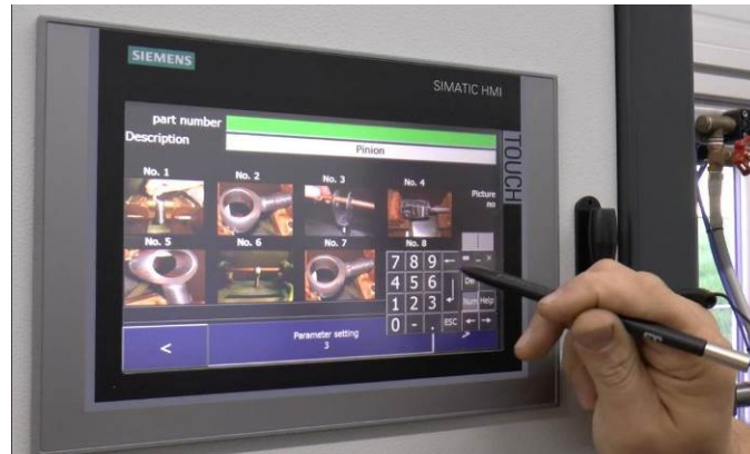
Bild Prüfteilauswahl. Mit der MEMORY-Software ist eine übersichtliche Bauteilauswahl über Fotos realisierbar.
