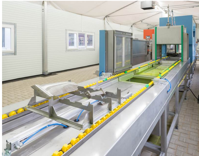
Bild Vollautomatische Penetrieranlage. Der Bauteiltransport zwischen den einzelnen Stationen ist über pneumatisch geschobene Werkstückträger vollautomatisiert. Die Bestandteile des Prüfmittelsystems (hier Eindringmittel, Waschwasser und Trockenentwickler) unterliegen einer vollständigen und komplexen Prozesskontrolle.
