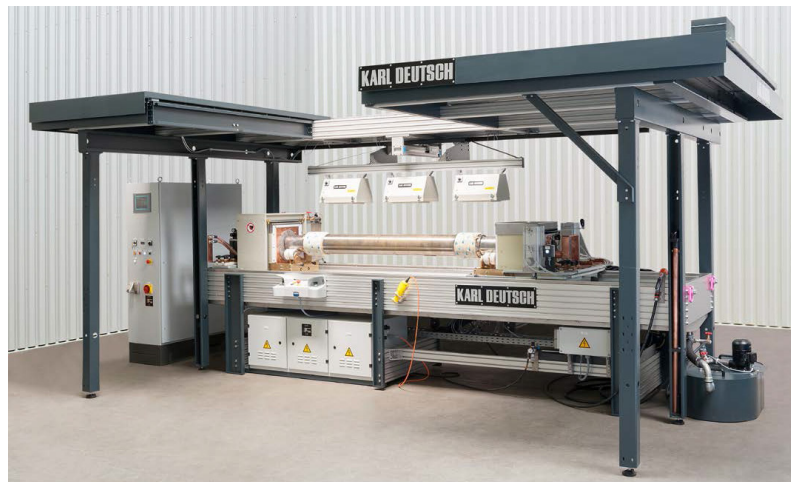
Bild Maschine mit Überlaufspule. Die gezeigte Prüfmaschine (Typ DEUTROFLUX UWS) für Bahnwellen verfügt über motorisierte Drehrollen zur allseitigen Betrachtung der Welle und eine Prüfkabine mit pneumatischer Dachöffnung zur komfortablen Beladung.
