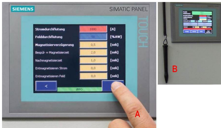
Bild Touch Panel. Bedienfeld des Parameter-Speichers für die Eingabe per Hand (A) oder per Stift (B).
