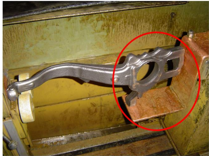
Bild Mangelhafte Prüftechnik. Bei beiden gezeigten Prüfteilen wäre zur Optimierung der Magnetisierung eine Prüfung mit drei Kontakten ratsam. Im linken Beispiel wird der markierte Teilbereich ungeprüft bleiben. Im rechten Beispiel ist nicht sichergestellt, dass sämtliche Oberflächen ausreichend und reproduzierbar magnetisiert werden.
