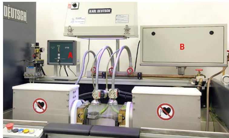
Bild Prüfmaschine mit Prüfmittelüberwachung. Das Bedien- und Anzeigemodul (A) gibt über eine farbige Balkenanzeige Auskunft über die Güte des Rissprüfmittels. Das Messmodul (B) ist ebenfalls direkt an der Maschine montiert.
