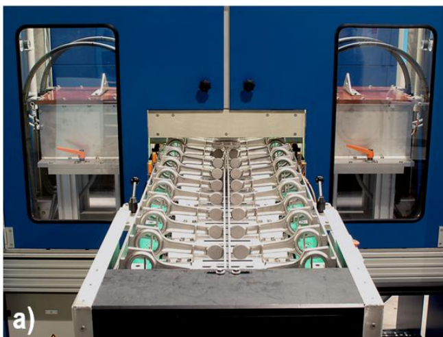
Bild Maschine mit Kettentransport für 4 Teile pro Takt. Pro Takt werden vier Pleuel mit zwei horizontalen Magnetisierstationen und zwei Mittenkontakten geprüft. a) Einlauf der Prüfmaschine, b) Detail der Magnetisierung.
