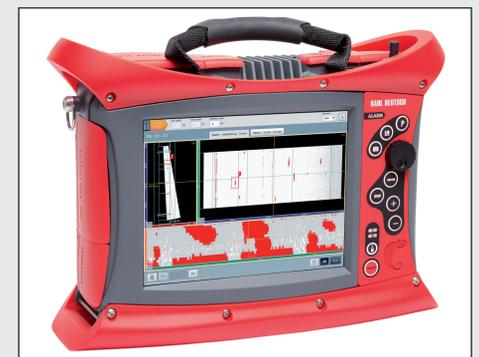
Handprüfung von Eisenbahnachsen im eingebauten Zustand
