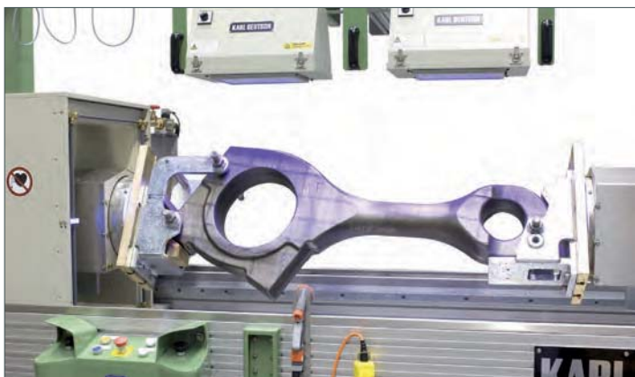
Prüfung von Schiffspleueln. Motorbetriebene Planscheiben zur Drehung des Pleuels innerhalb der Maschine während der visuellen Betrachtung. UV-Leuchten pneumatisch verschiebbar.
