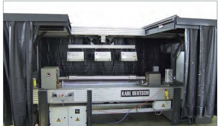
Maschine zur Prüfung von Radsatzwellen mit motorisch drehbaren Auflagerollen. Verdunklungskabine mit pneumatisch verschließbarer Dachöffnung und pneumatisch verschiebbaren UV-Leuchten.
