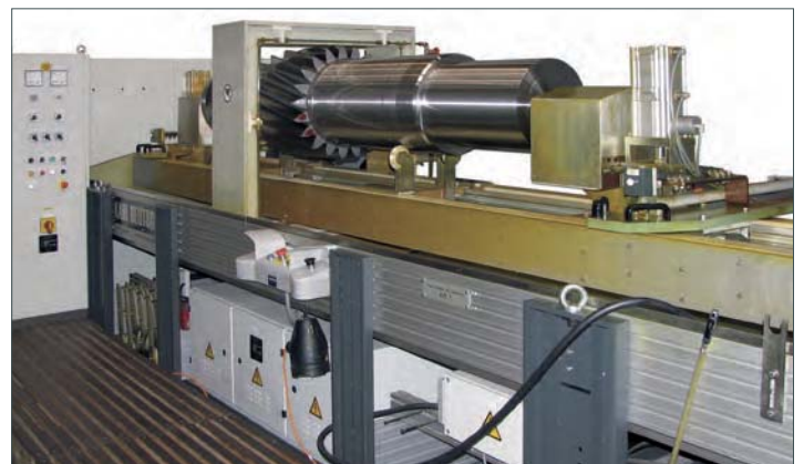
Prüfmaschine mit 5000 A zur Prüfung von bis zu 4 t schweren Getriebewellen. Durch Sonderführung des Werkstücks und schnell wechselbare Auflagerollen ist das DEUTROFLUX UWS für ein breites Spektrum verschiedenster Bauteile einsetzbar.
