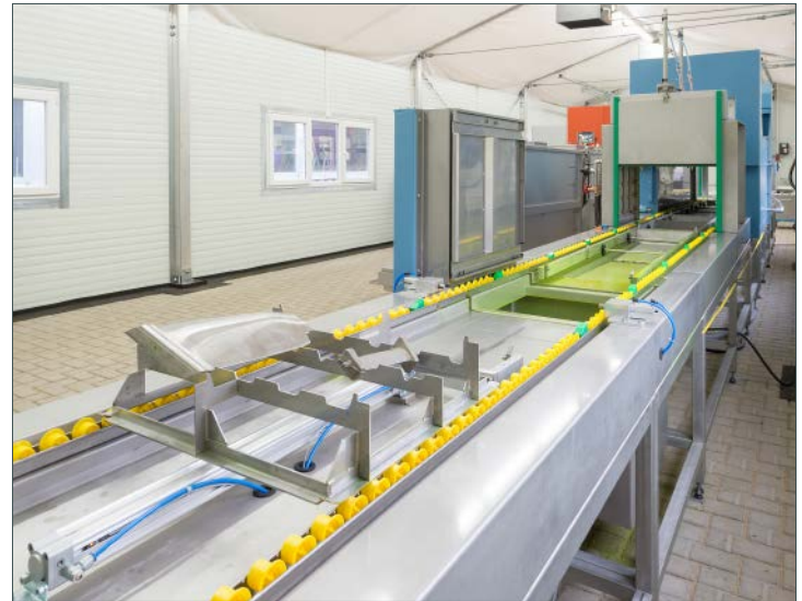
Linearer Anlagenaufbau mit Bauteiltransport über Rollenbahn und pneumatischem Vorschub der Werkstückträger. Aus Geheimhaltungsgründen sind keine Originalteile zu sehen.
