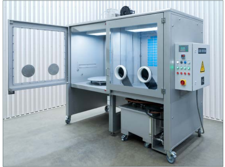
Sonderprüfplatz mit Spritzschutztüren und integrierter Trockenkammer
