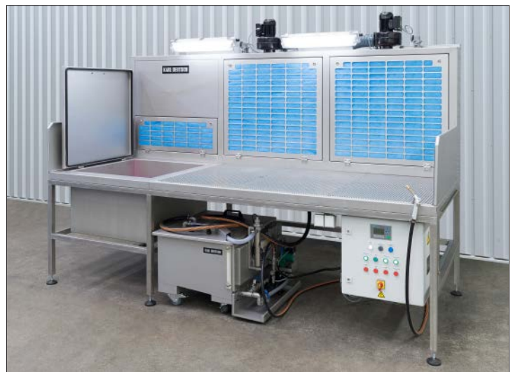
Prüfplatz mit Tauchbecken für die Prüfung mit rotem Farbeindringmittel und die Auswertung unter Tageslicht
