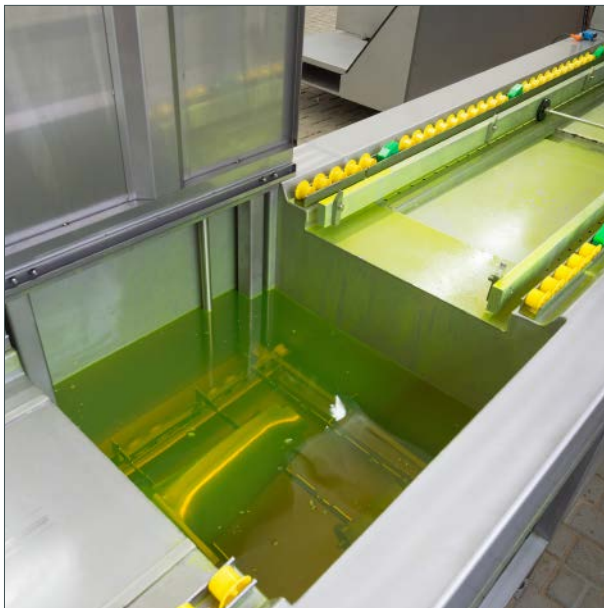
Der Prüfmittelauftrag erfolgt in einem Tauchbad.
