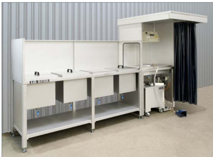
Technikumsanlage, nachemulgierbares Verfahren, für Gießereinstitut
