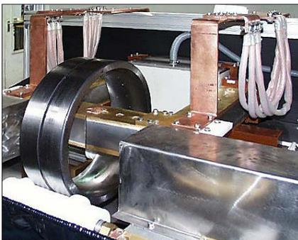
Die Prüfung von Lagerringen erfolgt mit einem Magnetisierdorn und in diesem Fall mit einem geschlossenen Joch (für große Feldstärken).
