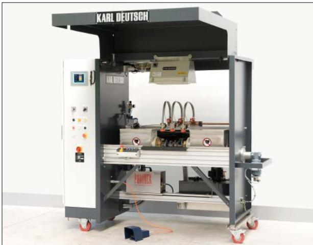
Die Prüfmaschine UWE 350 ist für Spannängen bis 350 mm ausgelegt. Dieses Beispiel zeigt eine mobile Prüfbank mit motorisierter Spannängenverstellung, MEMORY-SPS, Schwerlastrollen und Klappdach – perfekt für Dienstleistungsbetriebe.
