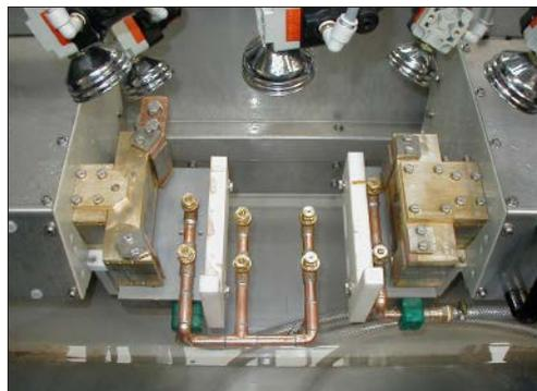
Werkstückaufnahme nun ohne Prüfteil. Im Bild sind die Düsen für die Bepülung von unten sichtbar.
