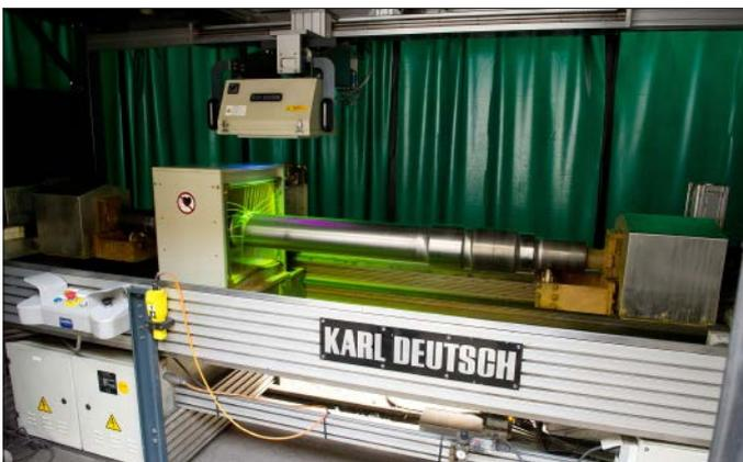
In vielen Werkstätten der DEUTSCHE BAHN AG erfolgt die Prüfung von Eisenbahnwellen mit Prüfmaschinen von KARL DEUTSCH.
