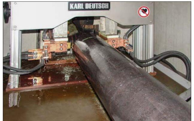
Nahtlose Rohre werden im Durchlauf mit einem Jochpaar und einer Spule magnetisiert.
