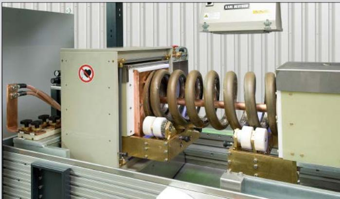
Die Prüfung von Eisenbahn-Federn erfolgt mit Hilfe der Strom-Längsdurchflutung und eines Kupferdorns.
