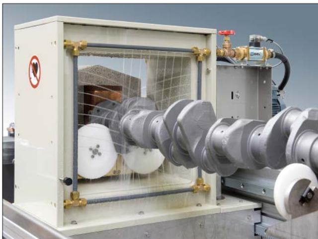
Überlaufspule mit Ringdüse zur Kurbelwellen-Prüfung
