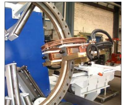
Großring-Magnetisierung bestehend aus einem Jochpaar und einer Klappspule.
