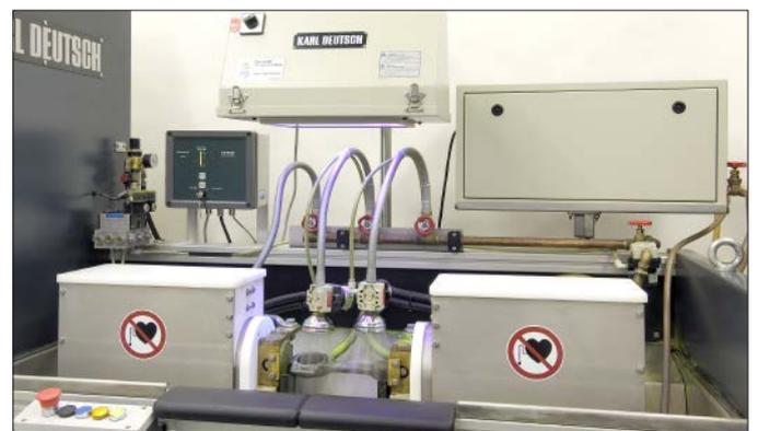
Mit FLUXA-Control wurde eine vollautomatisierte Prüfmittel-Überwachung realisiert, die alle zwei Minuten messtechnisch die Qualität des Prüfmittels überwacht.
