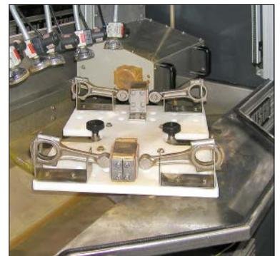
Drehbare Werkstückaufnahme mit Mittenkontakt zur Pleuel-Prüfung
