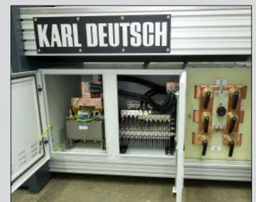
Umklemmvorrichtung zur Feld-Umschaltung (AC/DC, Luftfahrtteile)
