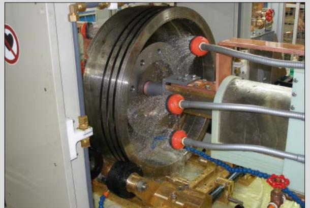
Das Bild zeigt die Prüfung von Großkolben für Schiffsmotoren mit einer UWS-Prüfmaschine.
