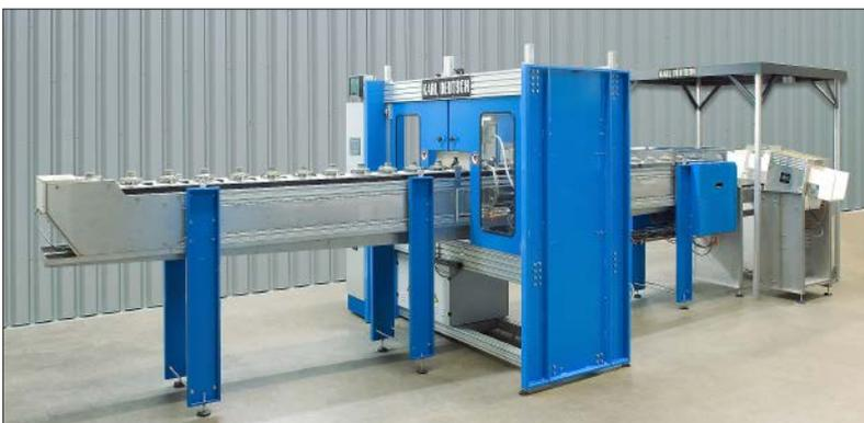
Das Bild zeigt eine Radnabenprüfung mit Kettentransport der Bauteile. Ähnliche Prüfmaschinen zur Prüfung von bis zu acht Prüfteilen pro Takt wurden bereits realisiert und bieten einen sehr hohen Durchsatz.
