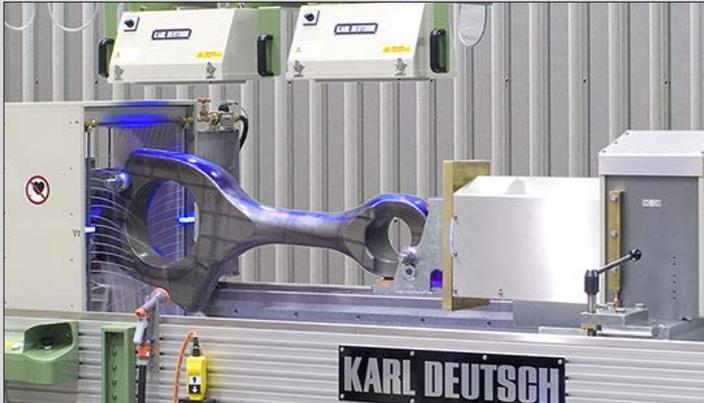
Die Prüfung von Schiffspleueln erfordert bauteilspezifische Werkstückaufnahmen und die Möglichkeit der motorisierten Bauteildrehung innerhalb der Prüfmaschine für eine komfortable Betrachtung.
