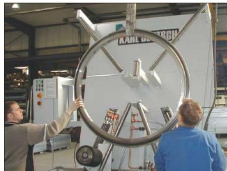
Große Ringe für Windkraftanlagen werden oft in vertikaler Position geprüft und während der Prüfung gedreht.
