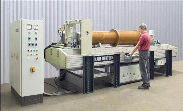
Prüfung einer großen Welle für die Energieerzeugung: Diese UWS-Prüfmaschine ist mit einer Traverse ausgestattet, um schwere Prüfteile aufzunehmen. Traverse und Prüfteil werden von der Überlaufspule umschlossen.
