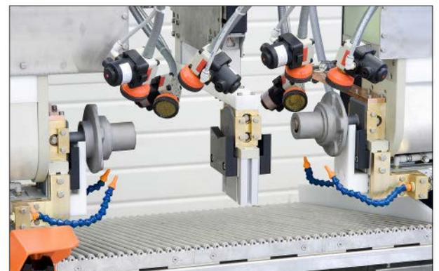
Diese Maschine mit Mittenkontakt erlaubt eine schnelle Radnabenprüfung (zwei Teile pro Takt). Über eine Bauteilrutsche wird die Prüfmaschine entladen.
