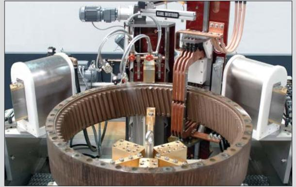
Große Zahnräder für Windkraftanlagen können mit einem Kreuzjoch unter Rotation geprüft werden.
