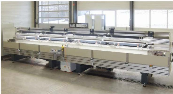
Diese HW-Stabstahl-Prüfanlage arbeitet mit einer Strom-Längsdurchflutung und erlaubt die Rotation und Betrachtung der Stäbe innerhalb der Anlage.
