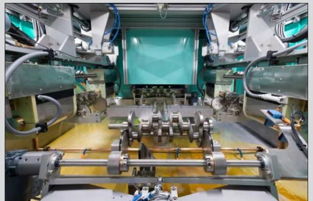
Dieser Rundtakttisch für Kurbelwellen enthält vier Stationen: Be- und Entladung, Magnetisierung, Betrachtung und Entmagnetisierung.
