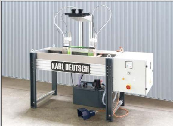
HW mit Stromselbstdurchflutung als Prüfmaschine zur Detektion von Längsrissen (Beispiel Drahtprüfung). Die Auswertung unter UV-Licht erfolgt in diesem Beispiel mit zwei herausnehmbaren UV-LED-Handleuchten.
