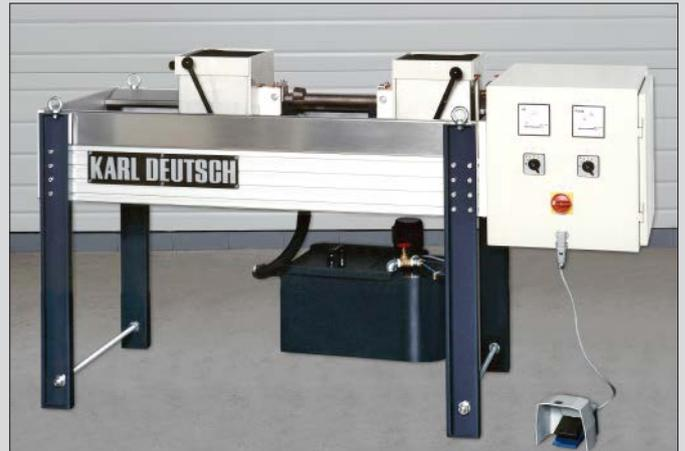
Die Prüfmaschine Typ EW mit kombinierter Magnetisierung (2 getrennte Feldkreise) ist für zwei Spannängen (300 bzw. 600 mm) erhältlich.
