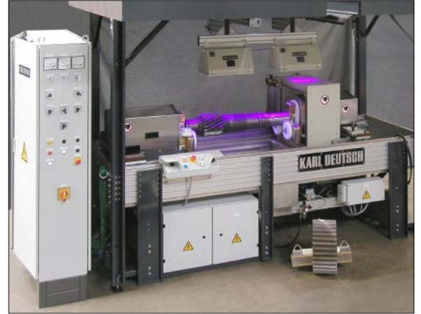
Diese UWS-Prüfmaschine weist zusätzliche UWE-Feldspulen auf und ist somit für lange und kurze Prüfteile einsetzbar. Im Bild sind exemplarisch eine Ritzelwelle und ein Zahnrad für die Energieerzeugung zu sehen.
