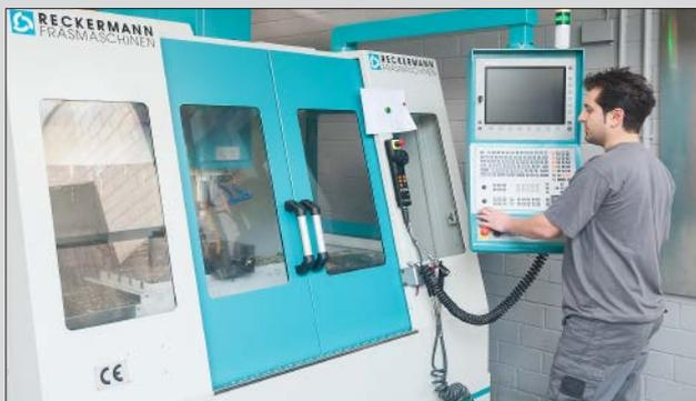
Ein moderner Maschinenpark ermöglicht die Eigenfertigung von Einzelteilen für den Sondermaschinenbau. Im Bild ist eine CNC-Maschine zu sehen, die CAD-Daten zur schnellen Fertigung einlesen kann.
