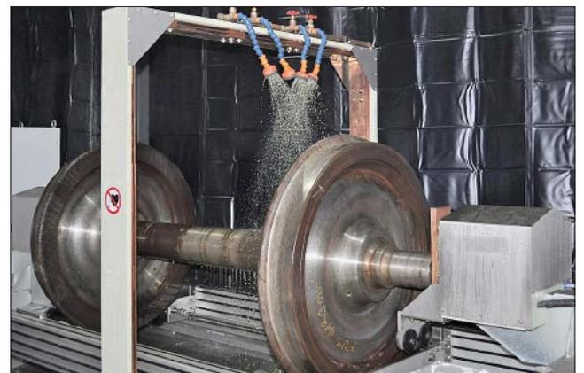
Die Eisenbahnwellen-Prüfung mit montierten Rädern kann durch Verwendung einer besonders großen Spule realisiert werden.
