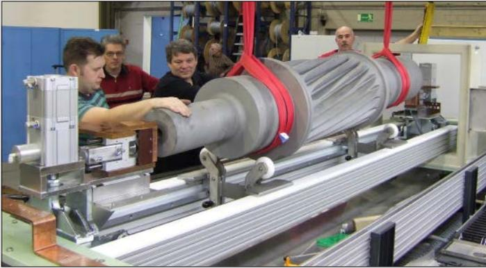
Die Prüfung einer Ritzelwelle mit 4 Tonnen Stückgewicht erfolgt mit einer Überlaufspule in Sonderbauform.
