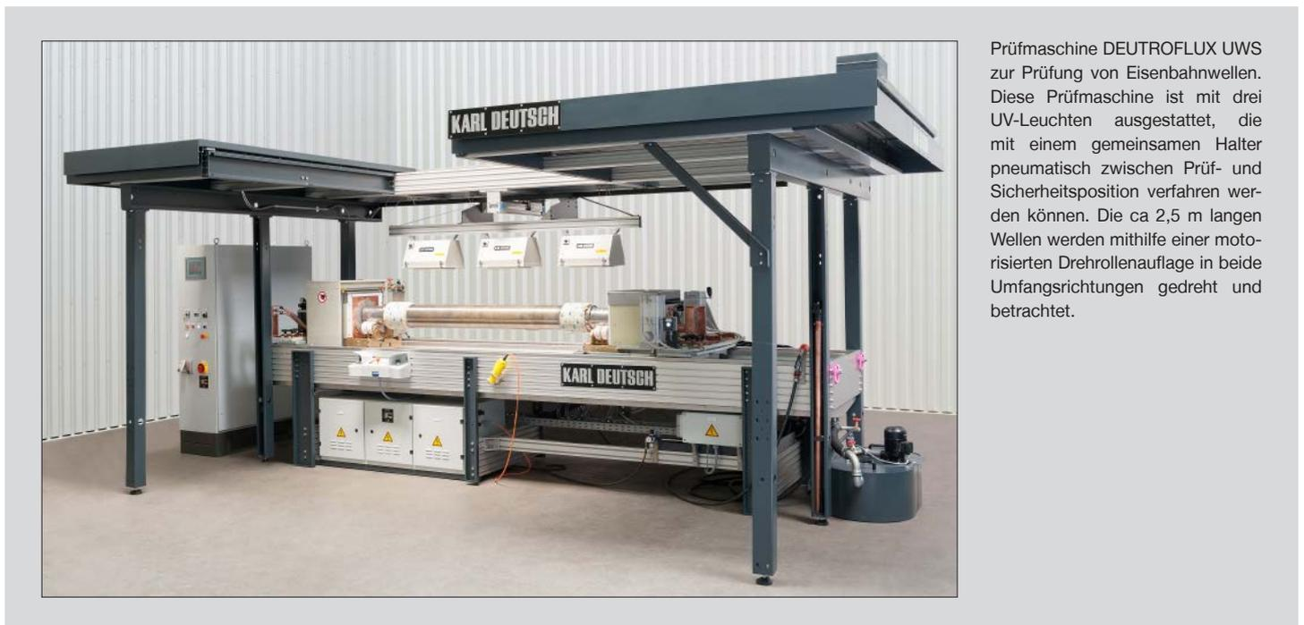
Prüfmaschine DEUTROFLUX UWS zur Prüfung von Eisenbahnwellen. Diese Prüfmaschine ist mit drei UV-Leuchten ausgestattet, die mit einem gemeinsamen Halter pneumatisch zwischen Prüf- und Sicherheitsposition verfahren werden können. Die ca. 2,5 m langen Wellen werden mithilfe einer motorisierten Drehrollenaufgabe in beide Umfangsrichtungen gedreht und betrachtet.
