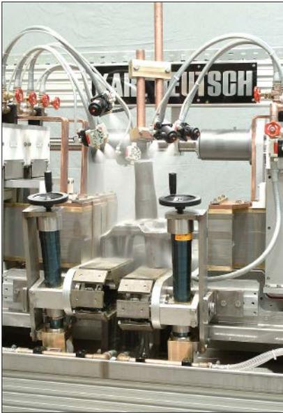
In diesem Beispiel werden LKW-Achsschenkel mit vier Kontakten geprüft. Die Beladung der Prüfmaschine erfolgt mit einem Roboter, die Entladung nach hinten über das im Bild sichtbare Panzerkettenband.
