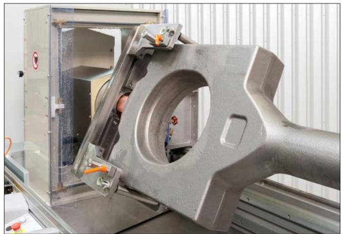
Stromkontakt in Sonderausführung für Schiffspleuel
