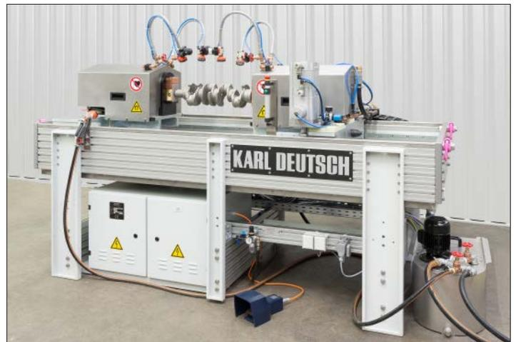
Dieses UWE in Sonderbauform mit einem niedrig ausgeführten Maschinengestell ist besonders gut für eine verkettete Prüflinie geeignet. Die Spannängenverstellung kann optional motorisiert und automatisiert ausgeführt werden.
