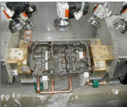
Werkstückaufnahme für ein komplex geformtes Gussteil
