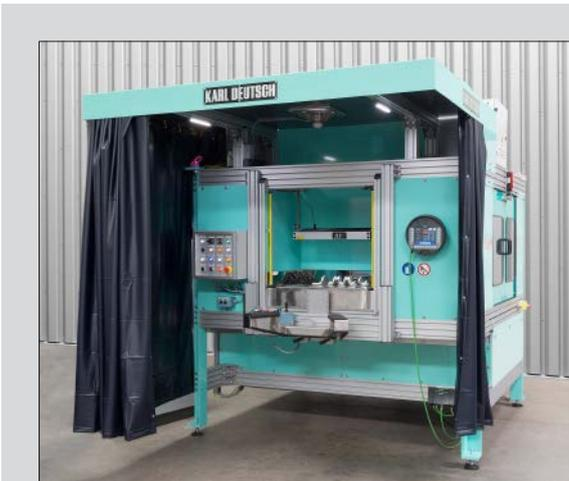
Prüfanlagen als Rundtakttisch erlauben eine effiziente Be- und Entladung, z. B. über einen Roboter.
