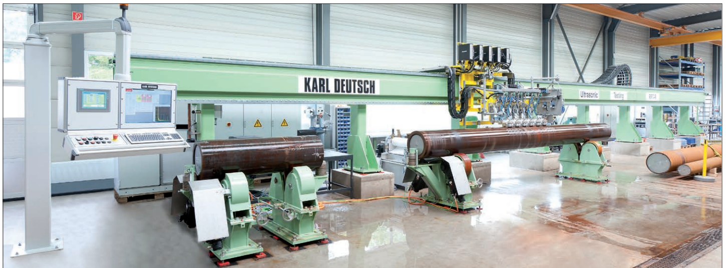
Prüfportal für nahtlose Rohre mit 6 Prüfkopfhaltern und insgesamt 30 Prüfköpfen
