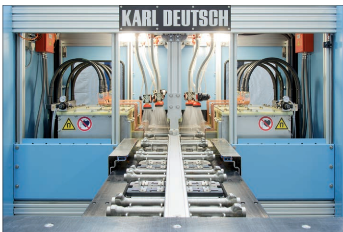
DEUTROMAT mit Kettenförderer, 8 Prüfteile pro Takt
