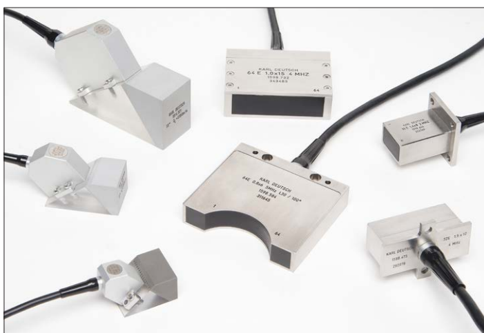
Gruppenstrahler-Prüfköpfe zur Schweißnahtprüfung an Rohren
