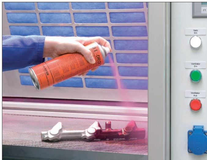
Prüfung eines Schmiedeteils mit rotem Farbeindringmittel
