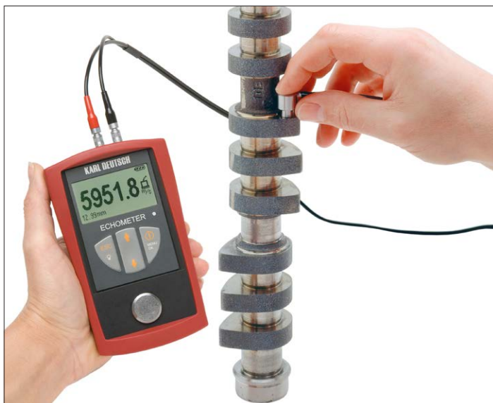
Messung der Schallgeschwindigkeit an einer Nockenwelle (ECHOMETER 1076)
