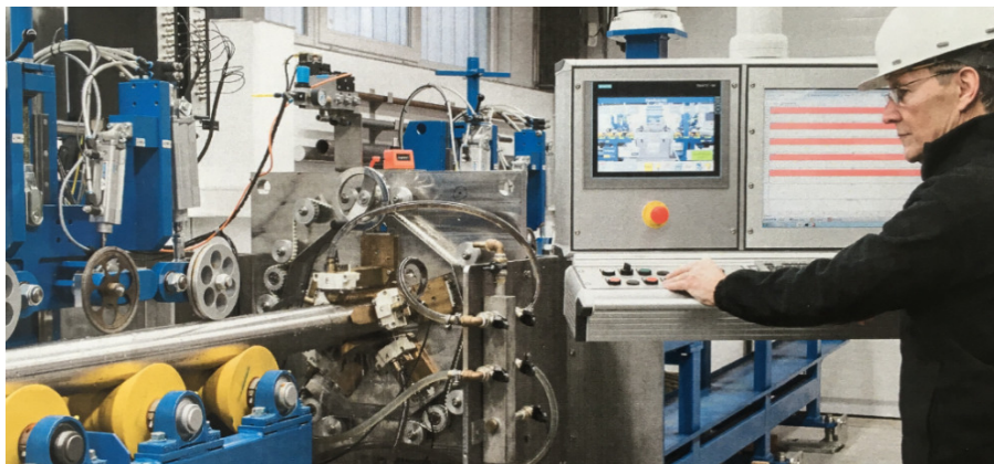
Abb. 11. ECHOGRAPH-STPS-PAUT-Prüfanlage mit 5 PAUT-Prüfköpfen und Squirter-Ankopplung.
