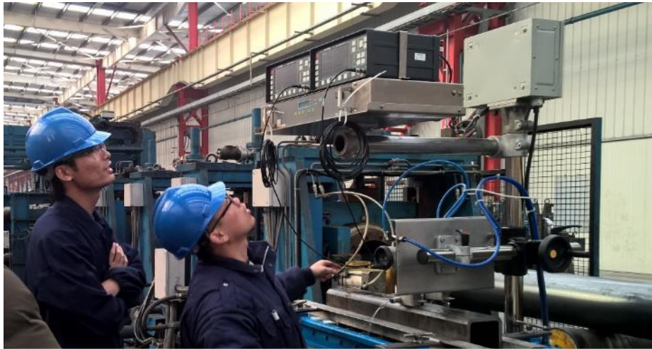
Abb 3. Zweikanalige HF-Schweißnahtprüfung als Prozesskontrolle am Endlosrohr (unten rechts im Bild).
