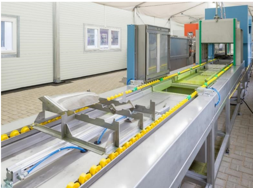
Abb. 7. Gesamtansicht einer vollautomatischen KD-Check-Prüfanlage für Schmiedeteile (aus Gründen der Geheimhaltung sind die Original-Prüfteile nicht im Bild zu sehen).
