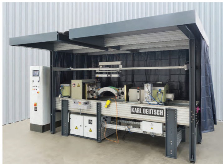
Abb. 6. MT-Prüfung von Rohrleitungs-Klemmsätzen bei der Firma DESTEC in Washingborough, UK.
