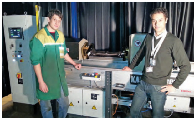
Abb. 5. MT-Prüfung von Seilbahn-Komponenten bei der Firma LEITNER in Sterzing, Italien.
