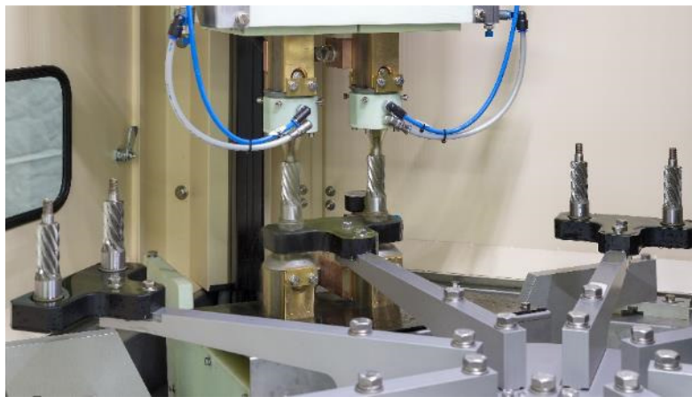
Abb. 2. MT-Prüfung von Lenkritzeln (Rundtaktisch mit acht Auslegern und zwei Prüfteilen pro Ausleger).
