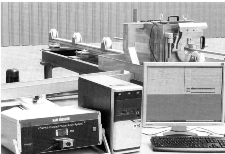
Bild 10. Prototyp einer Stangenprüfanlage mit Gruppenstrahlertechnik (mit freundlicher Genehmigung der Fa. Karl Deutsch Prüf- und Messgerätebau, Wuppertal)
