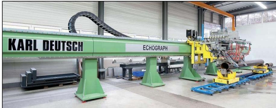
Abb. 1: Portal für die Offline-Schweißnahtprüfung
