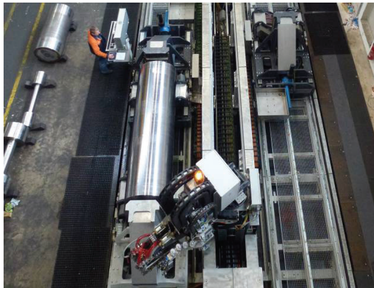
Bild 5. Schwenk je einer Prüfkopfhalterung pro Kopfseite des Portals zwischen den beiden Prüfstationen (im Bild ist nur eine der beiden baugleichen Prüfkopfhalterungen zu sehen)
