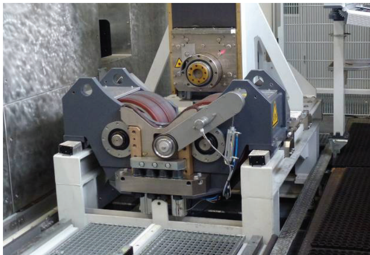
Bild 3. Drehrollenstation mit Dämpferbaugruppe ausgelegt für hohe Bauteilgewichte
