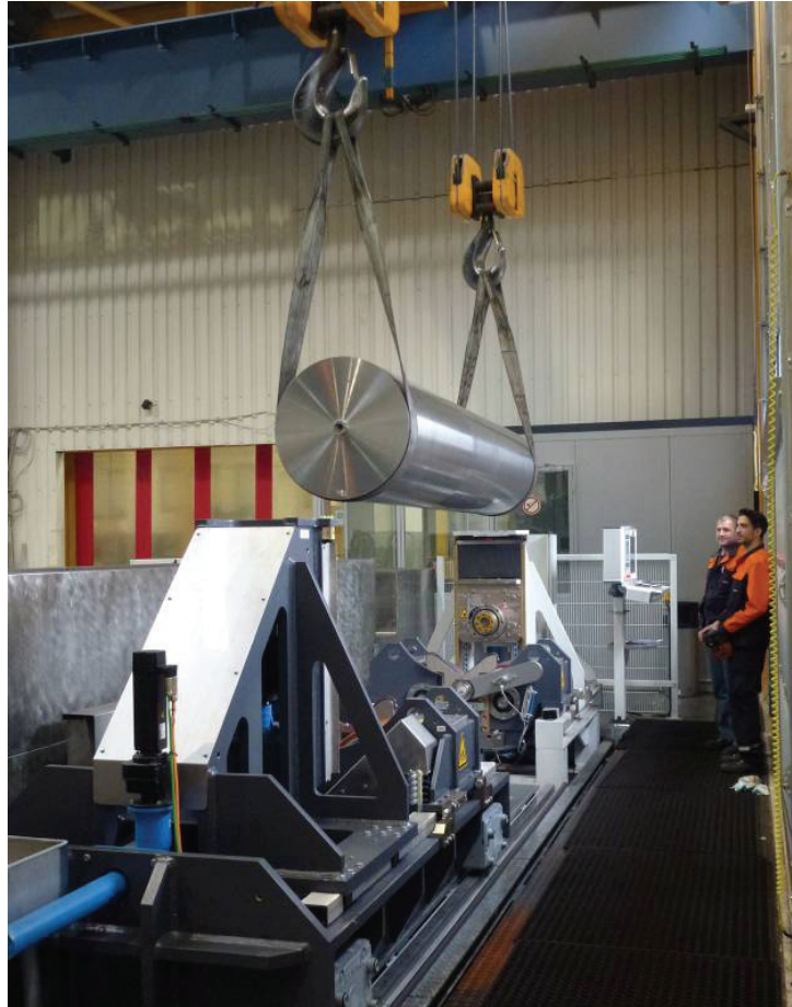
Bild 4. Beladung der Prüfanlage per Kran
