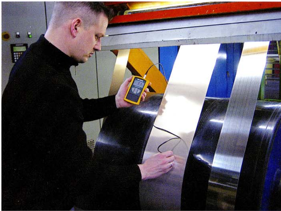
Bild 2. Praxisbeispiel: Messung an beschichtetem Bandstahl
