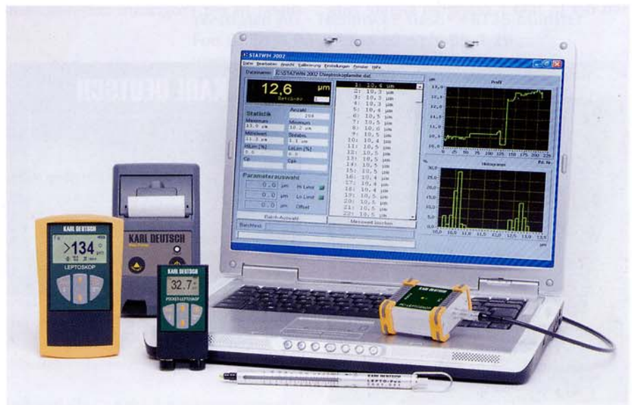
Bild 1. Leptoskop-Familie: Leptoskop 2042, Akku-Drucker, Pocket-Leptoskop, PC-Sonde (v. l. n. r.)
