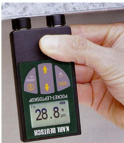
Bild 3. Pocket-Leptoskop mit gedrehter Anzeige
